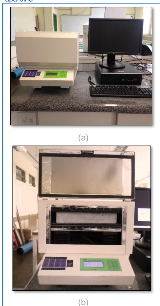
Figura 16 - Instrumentação do ensaio de condutividade térmica: (a) Visão geral do ensaio; (b) Visão aproximada do corpo de prova no aparelho
