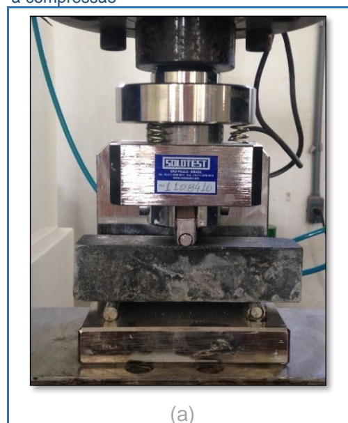
Figura 14 - Instrumentação dos ensaios: (a) Resistência à tração na flexão; (b) Resistência à compressão
